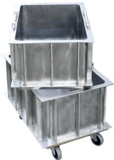
Die Box ermöglicht durch eine optimale Druckbeaufschlagung die Reifung von Fleisch. Durch die Pressung der Teilstücke in der Box wird das Wachstum von Milchsäurebakterien weitestgehend verhindert. Das Fleisch reift somit unter anaeroben Bedingungen (ohne Sauerstoff). Mit diesem Verfahren erhält Ihr Fleisch eine zarte Konsistenz und einen aromatischen Geschmack.
